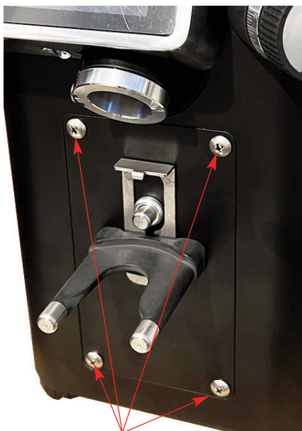
Die 4 Schrauben des Moduls abschrauben
