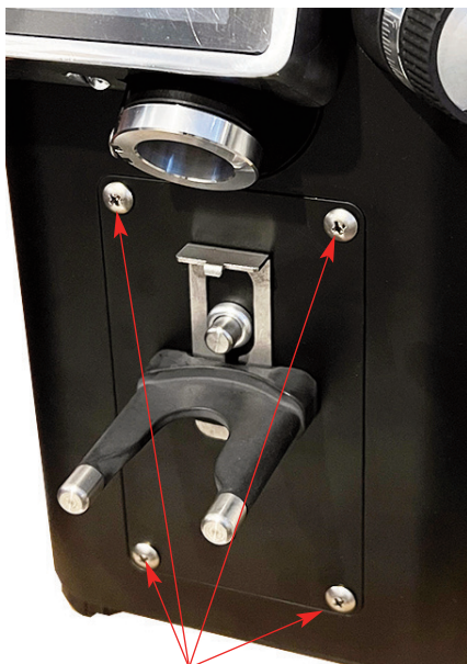
Desatornillar los 4 tornillos del módulo
